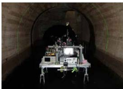
図-1 壁面連続画像計測状況
