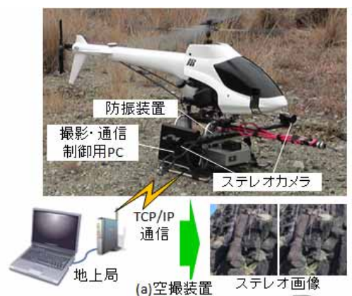
図1 岩盤斜面の遠隔非接触計測システム
