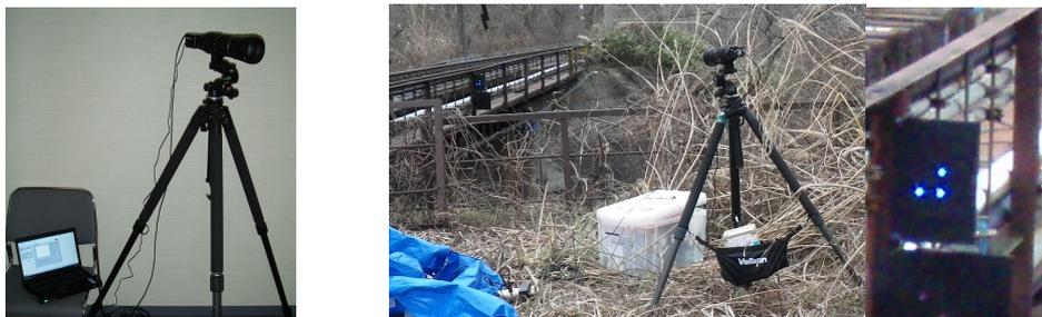
図-1 左：光学式変位計システム概要 右：現地計測設置状況とターゲット例
