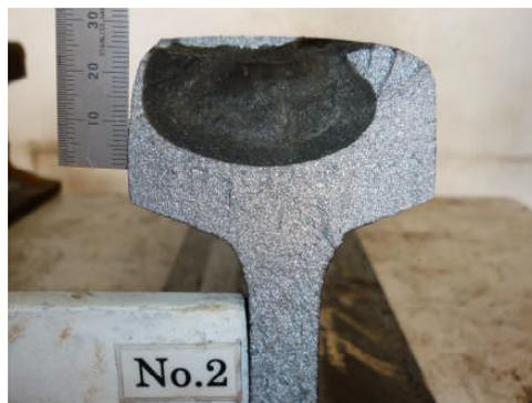
図5 シェリングレール破断面
