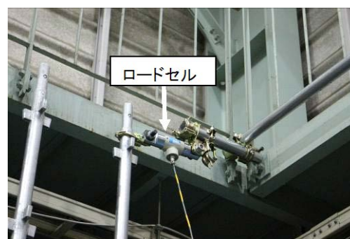
写真 4 ひかえに取り付けたロードセル
