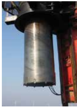
図-5 杭先端ビットおよび中掘りオーガー
