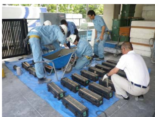
写真-1 杉板・剥離剤試験
