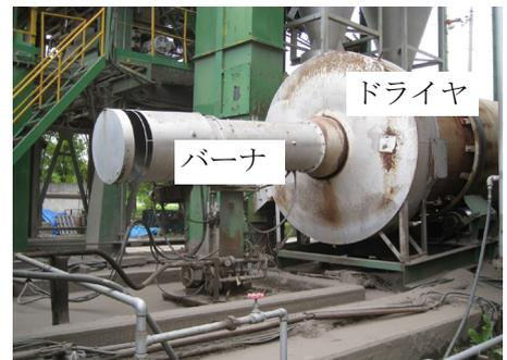
写真-1 骨材加熱ドライヤ用のバーナ
