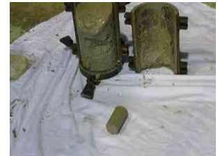
図-3 材齢 1h 後の脱型状況
