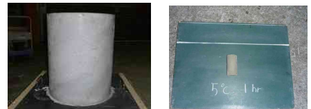
図-5 脱型後と割裂試験後の様子
