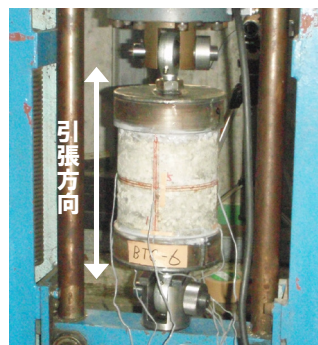
写真-1 直接引張試験状況
