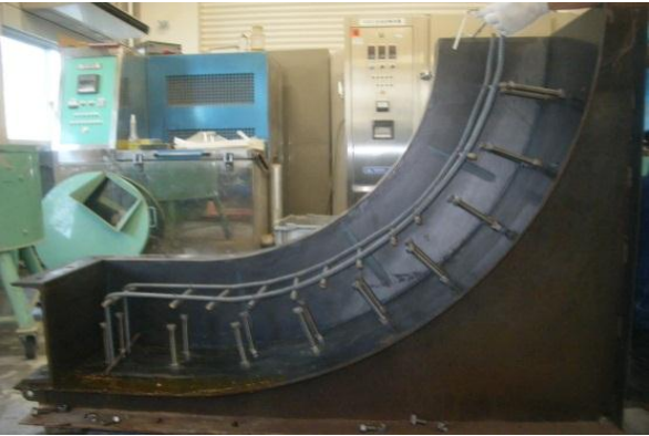
写真-1 模型型枠(鉄筋+スタッド)
