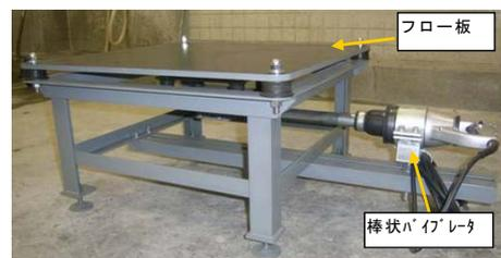
写真-1 加振変形試験機
