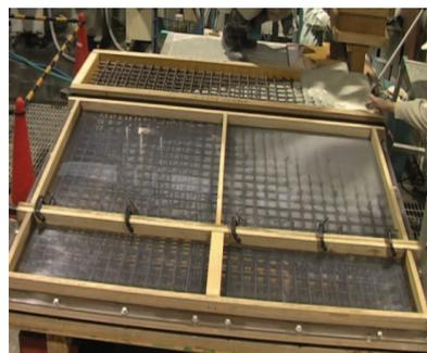
写真-1 スラブ状型枠への充填状況
