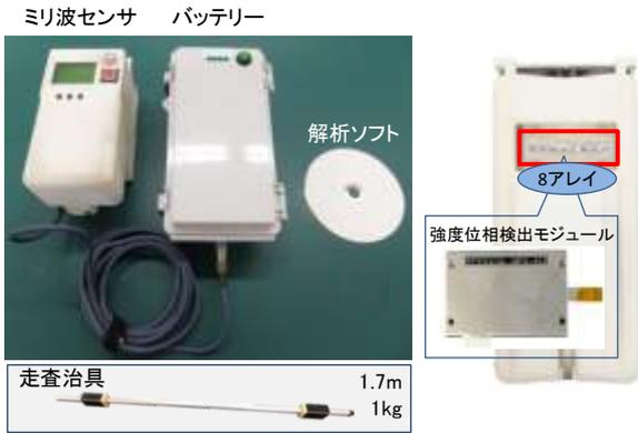
図-2 ひび割れ検査装置一式（左）、ミリ波センサ（右）
