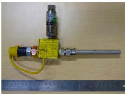
**図-1** 小型円筒形加力装置（ジャッキ）の外観
