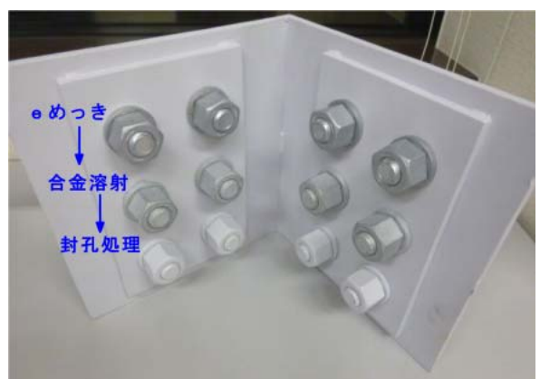
写真-3 二重防錆ボルトの施工手順
