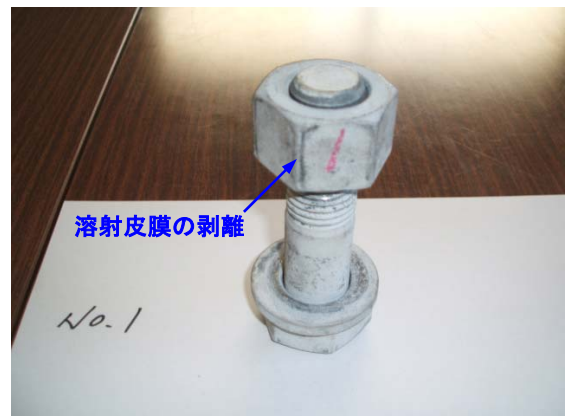
写真-2 溶射高力ボルトの締付けによる被膜剥離
