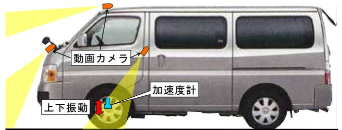
図-1 多機能路面測定システムの概要
