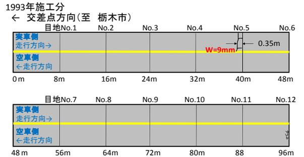
図 2 ひび割れ発生状況の例(1993年施工分)
