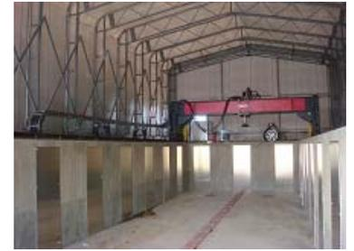
写真-1 繰り返し荷重試験装置
