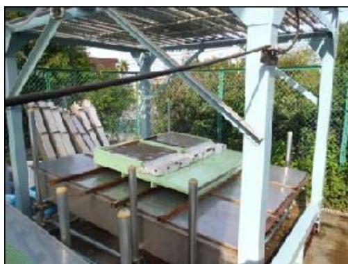
図1 人工降雨装置と試験用型枠設置状況
