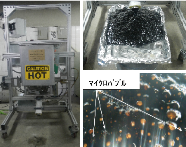
写真-1 マイクロバブル発生装置 写真-2 マイクロバブル発生状況
