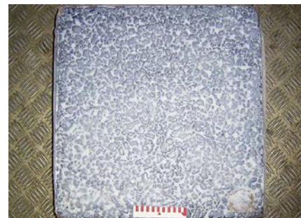
写真-1 作製した凍結路面（排水性舗装）
