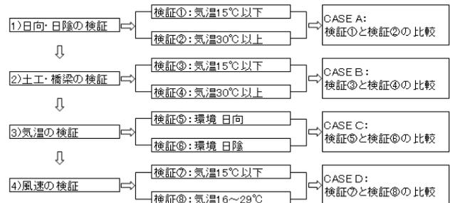
図-1 検証条件のフロー図(高機能舗装I型)
