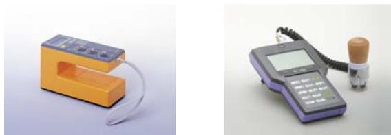
(a) 高周波容量式水分計A (b) 電気抵抗式新型水分計B
