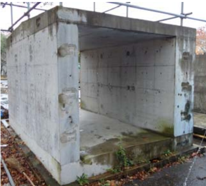
(c) ボックス型供試体 (寸法：2,450×2,900×4,100 mm) 写真 1 共通試験供試体
