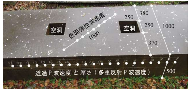
写真-1 空洞供試体
