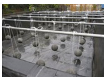
写真2 試験体設置状況
