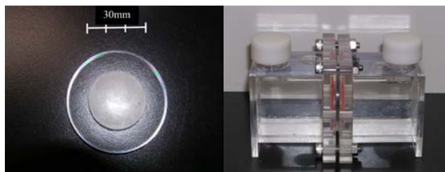
写真—1 透過拡散セル（左：試験体、右：セル容器）
