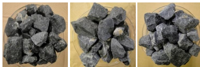
a) 1サイクル目 b) 2サイクル目 c) 3サイクル目 写真-2 回収後の粗骨材（絶乾状態）
