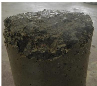
写真-1 シリンダの劣化状況
