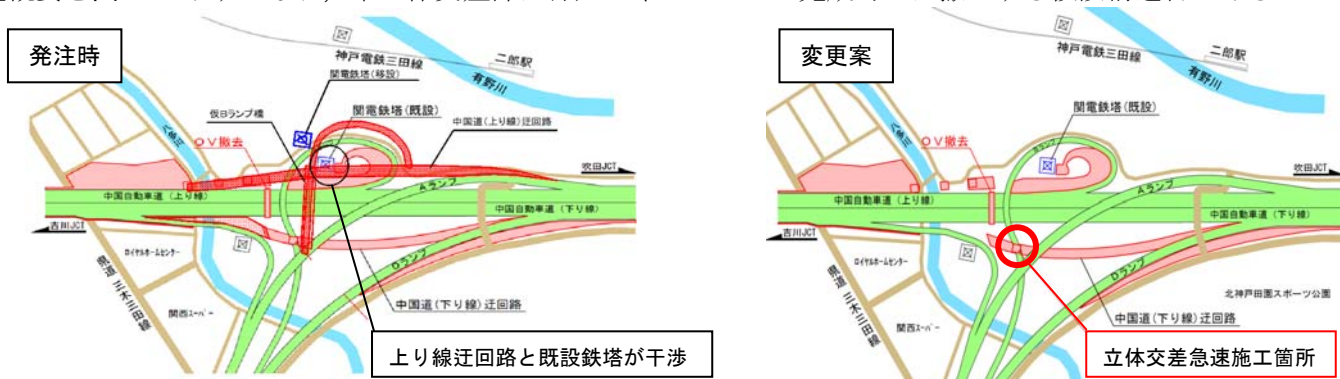
図-1 計画平面図（発注時および変更時）
