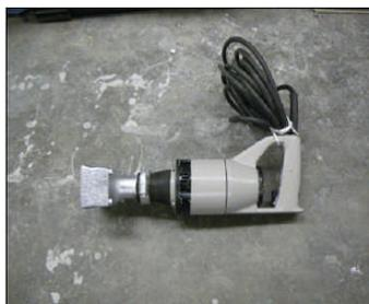
写真-1 従来型バイブレータ
