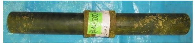
図 7 圧縮試験前の管の一例 (最大荷重 200.5kN 1966 年埋設)
