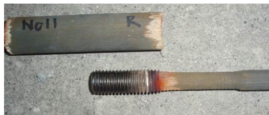
図 6 供試体の腐食状況 (供試体 No.11)
