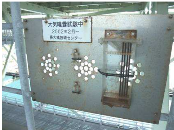
写真-1 試験体暴露状況（回収前）
