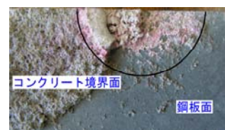
写真-4 滞水試験底面鋼板状況(吹き付け 1mm) (左：全体、右：注水孔付近拡大)
