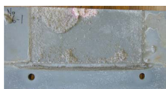
写真-4 滞水試験底面鋼板状況(吹き付け 1mm) (左：全体、右：注水孔付近拡大)
