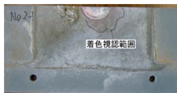
写真-3 滞水試験底面鋼板状況(吹き付けなし) (左：全体、右：注水孔付近拡大)
