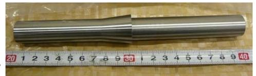
写真-1 テーパ型先端定着を有するアンカー
