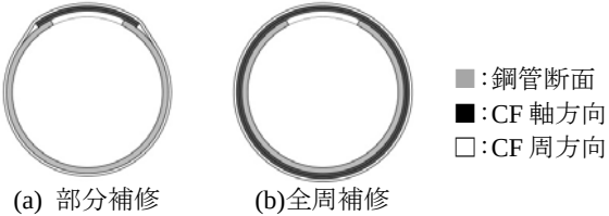
図 1 補修方法の概略
