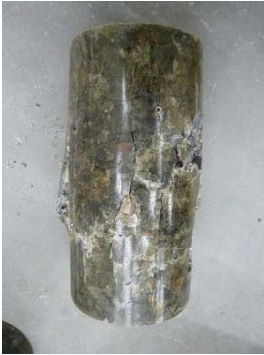
写真-1 圧縮試験後の試験体
