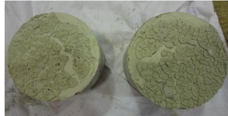
(c) 注入後硬化された止水材料
