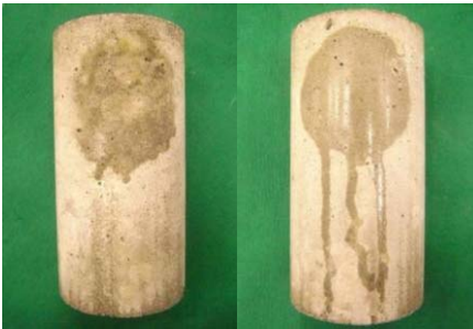
塗布なし 塗布あり 写真-1 撥水性確認
