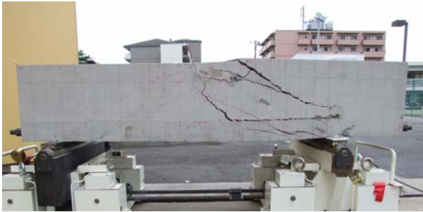
写真-1 B0-1 破壊状況（側面）
