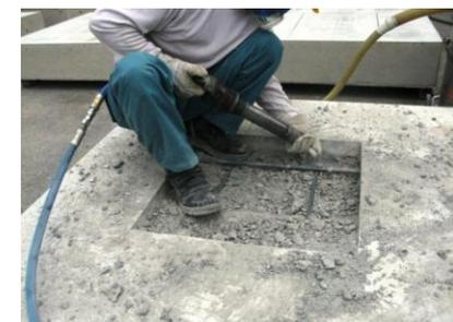
写真 - 3 模擬供試体のハツリ状況
