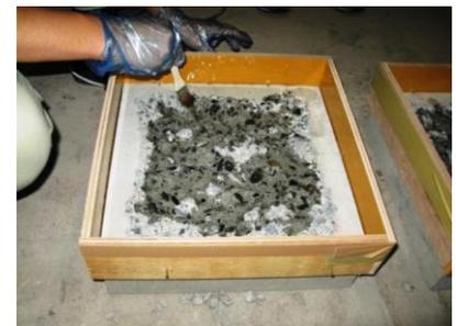
写真 - 2 試験板への浸透接着剤塗布
