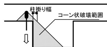
図-5 アンカーの引抜き耐力
