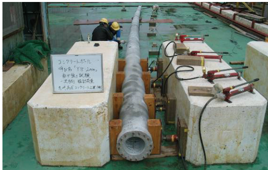
写真-1 曲げ試験状況
