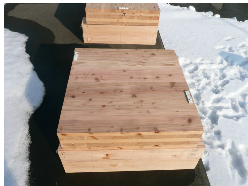
写真1 CLTの目地部分の動き測定 (左設：置当初、右約：2ヶ月後)
