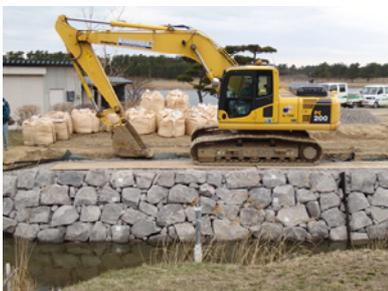
図6 重機による載荷試験
