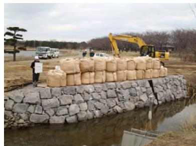
図7 重りによる載荷試験
