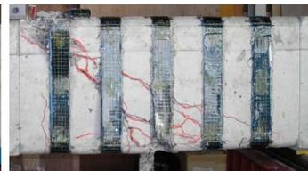
写真-2 No. 3 破壊形態
