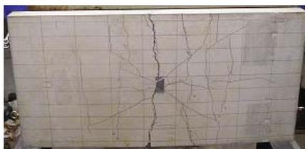
図-4 RC-12の破壊状況(7.5m/s)
