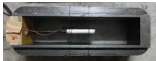
図 1 埋設ゲージによる自己収縮ひずみの計測
